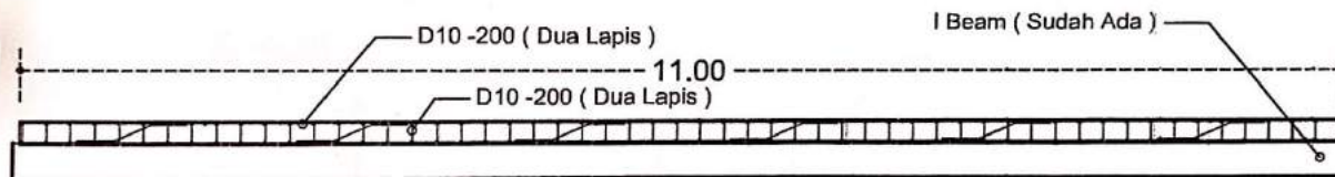
Detail Pembesian Plat Lantai Memanjang Skala 1;100
